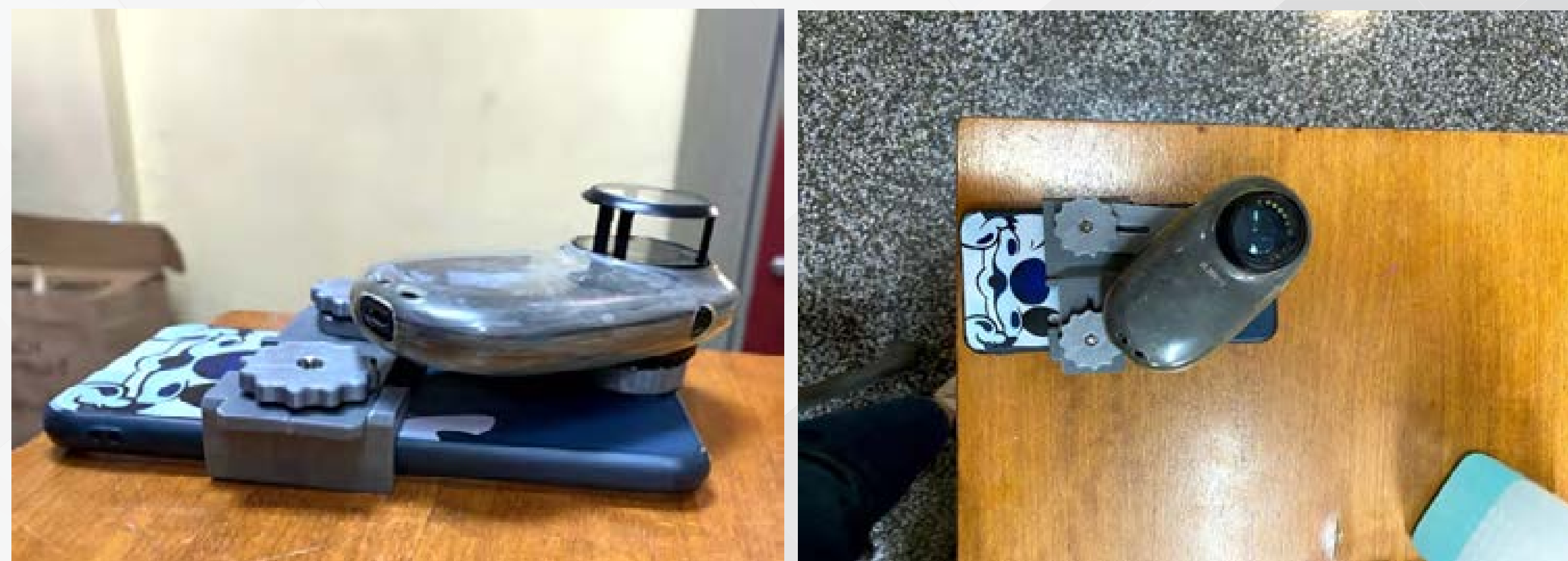
Dermoscopio montado sobre dispositivo, con la lupa desplegada y sin encender su luz
